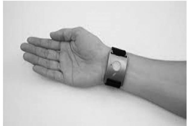
図 3 Q センサーの取り付け
